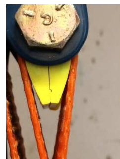
Обе ножки лежат друг против друга, а выпуклость находится в углублении. Прилагаемое усилие предварительного натяжения составляет 1000 даН.
