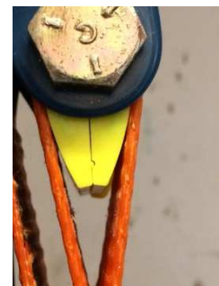
Obie nogi leżą naprzeciw siebie, a wybrzuszenie leży w zagłębieniu. Stosowana siła naprężenia wstępnego wynosi 1000 daN.
